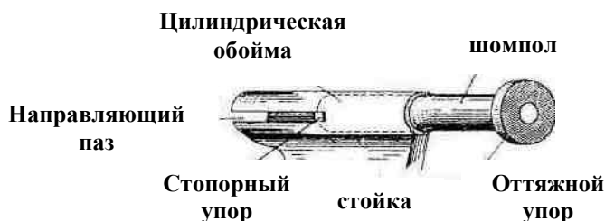
Рис. 28. Запирающее устройство шомпольного замка в открытом положении
