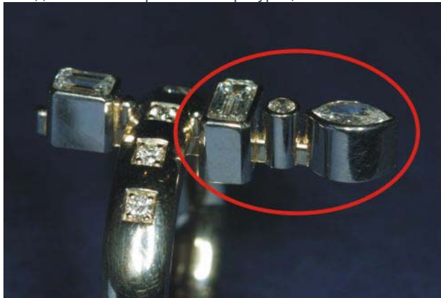
Крапановый кафт с выпильными крапанами.
