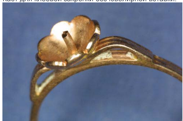
Каст для клеевой закрепки без ювелирной вставки.
